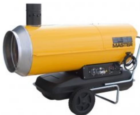
Тепловая пушка **MASTER BV 290 E** «придется ко двору» в том случае, когда необходимо обогреть большие помещения. Эта модель оснащена всем, что может обеспечить чистый и теплый воздух в большом объеме пространства: большой и мощный вентилятор, «умная» электронная система стабилизации пламени. В комплексе все это дает мощность 81 Квт.
